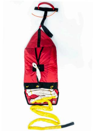
将伞绳折叠成与外包宽度近似的对称的一个个捆，然后使用橡皮筋固定住伞绳捆，并将伞绳捆捆整齐的叠放在整个副伞包的下方。
