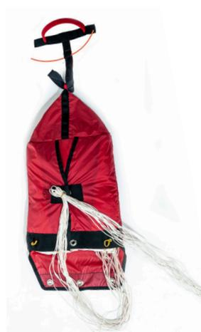
从头量取 60cm 副伞绳并折叠。用中间的橡皮筋进行固定。
